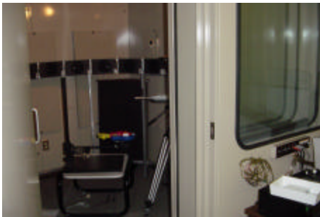
Figure 2 et 3 : La figure 1 (photo à gauche) montre la cabine insonore utilisée et la figure 3 (photo de droite) montre le montage de mesure sonométrique utilisé – ici la mesure selon B-4 tirée de (26)
