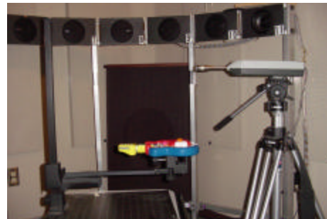
Figure 2 et 3 : La figure 1 (photo à gauche) montre la cabine insonore utilisée et la figure 3 (photo de droite) montre le montage de mesure sonométrique utilisé – ici la mesure selon B-4 tirée de (26)
